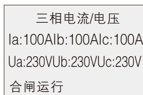
图4 合闸成功界面： 断路器合闸成功显示剩余电流 界面和三相电流/电压界面，可 用“上”、“下”键切换
